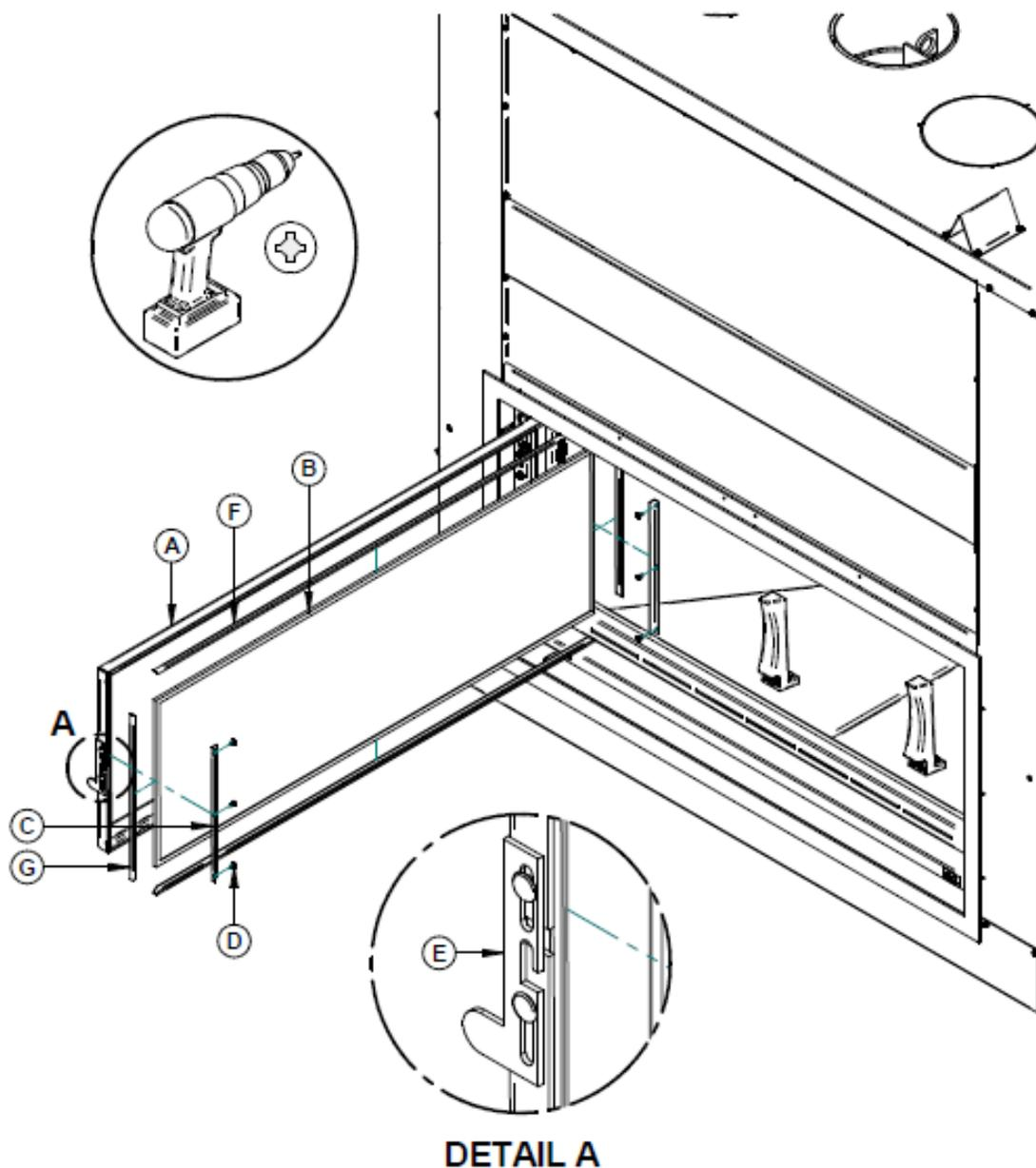
Figure 55 : Remplacement de la vitre
