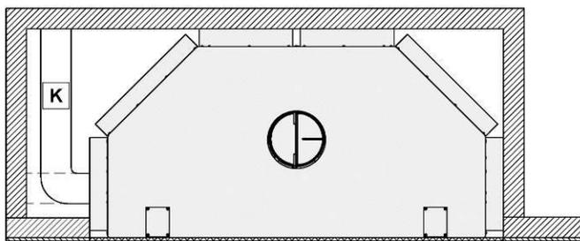
Figure 21 : Entrée d'air frais sur le côté
