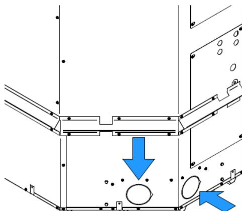
Figure 27 : Localisation des prises d'entrée d'air frais
