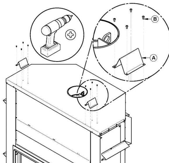
Figure 12 : Installation des cales d'espacement
