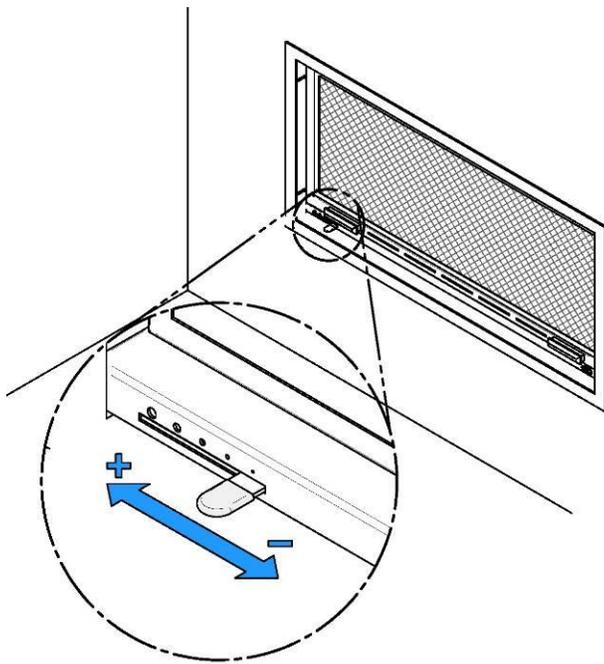
Figure 53 : Contrôle d'entrée d'air frais
