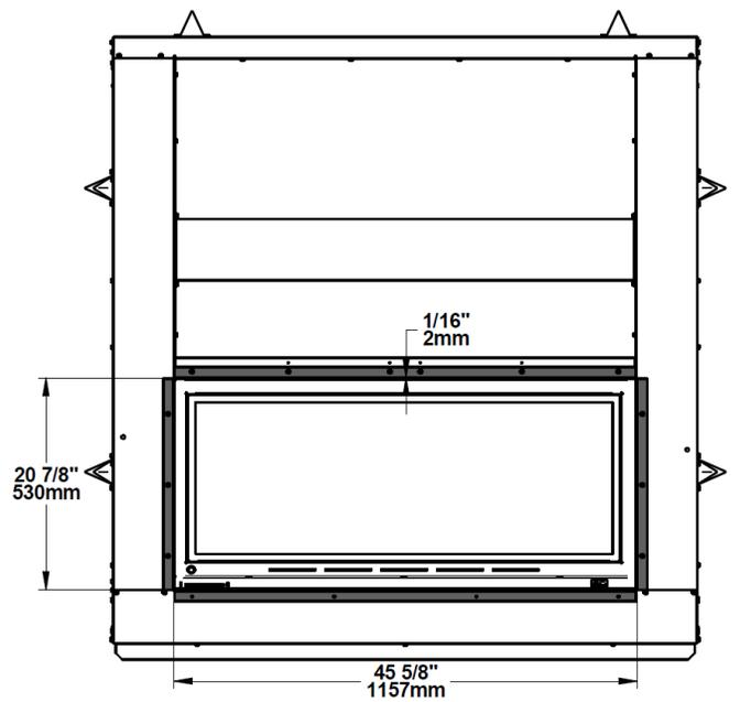
Figure 4 : Contour de finition pour maçonnerie
