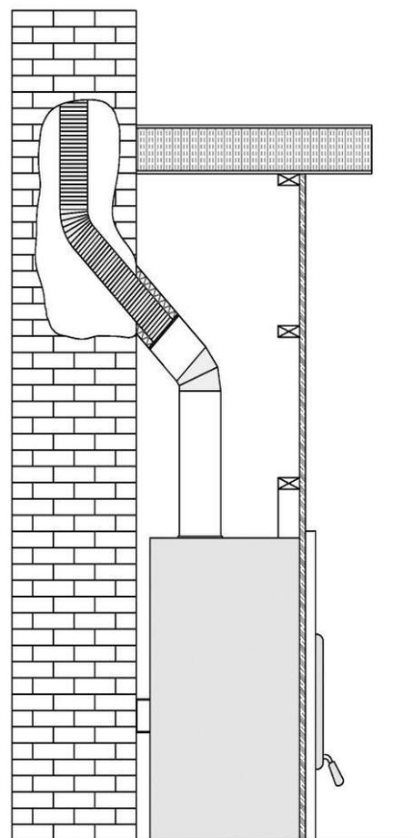
Figure 47 : Connexion à une cheminée de maçonnerie
