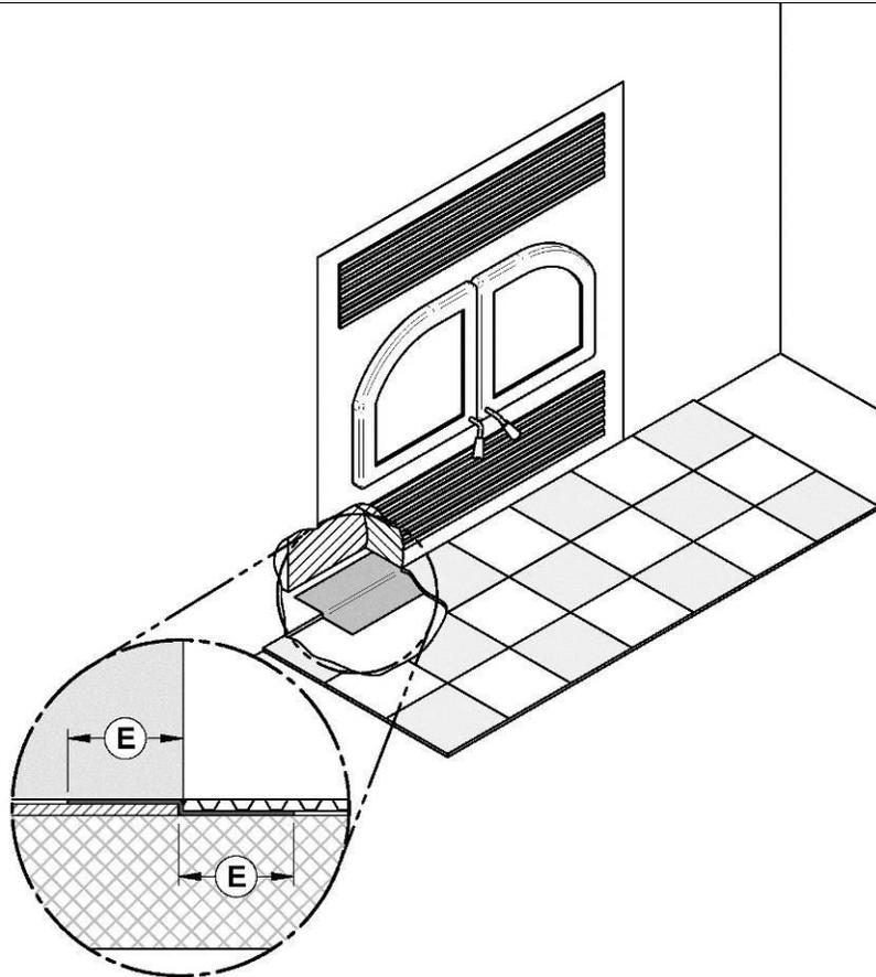
Figure 17 : Installation directement sur le plancher
