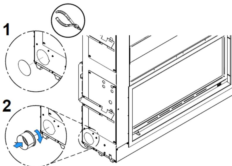
Figure 28 : Installation de l'adaptateur
