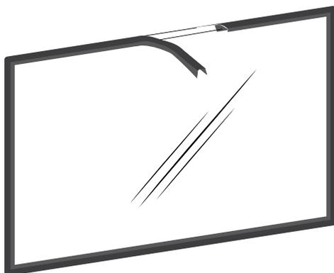
Figure 57 : Joint d'étanchéité de la vitre
