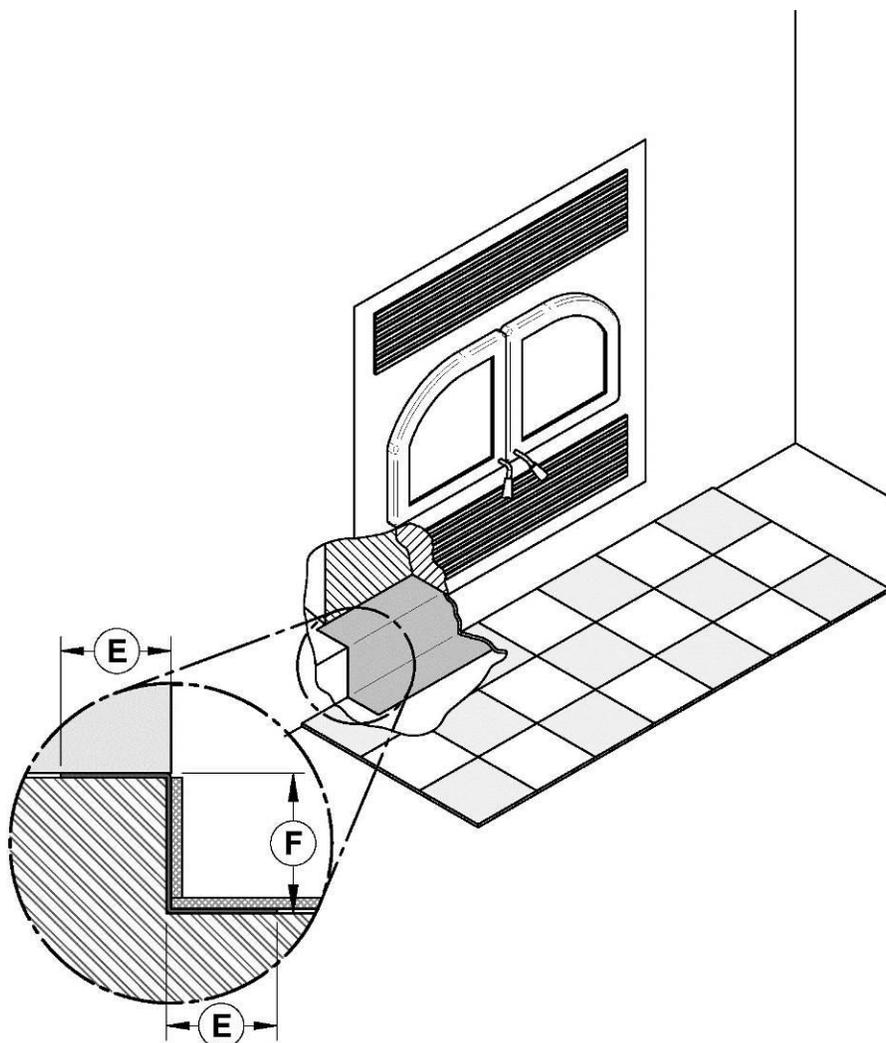
Figure 16 : Installation sur une base surélevée de 4"
