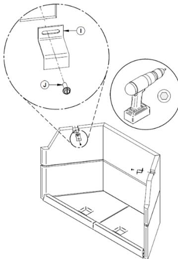
Figure 39 : Dispositifs de retenue des panneaux
