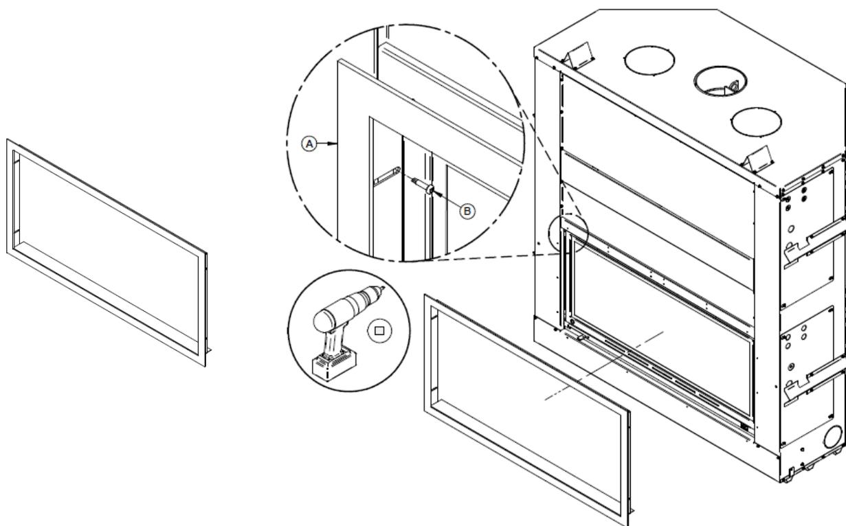
Figure 31 : Installation de la façade à bandes étroites
