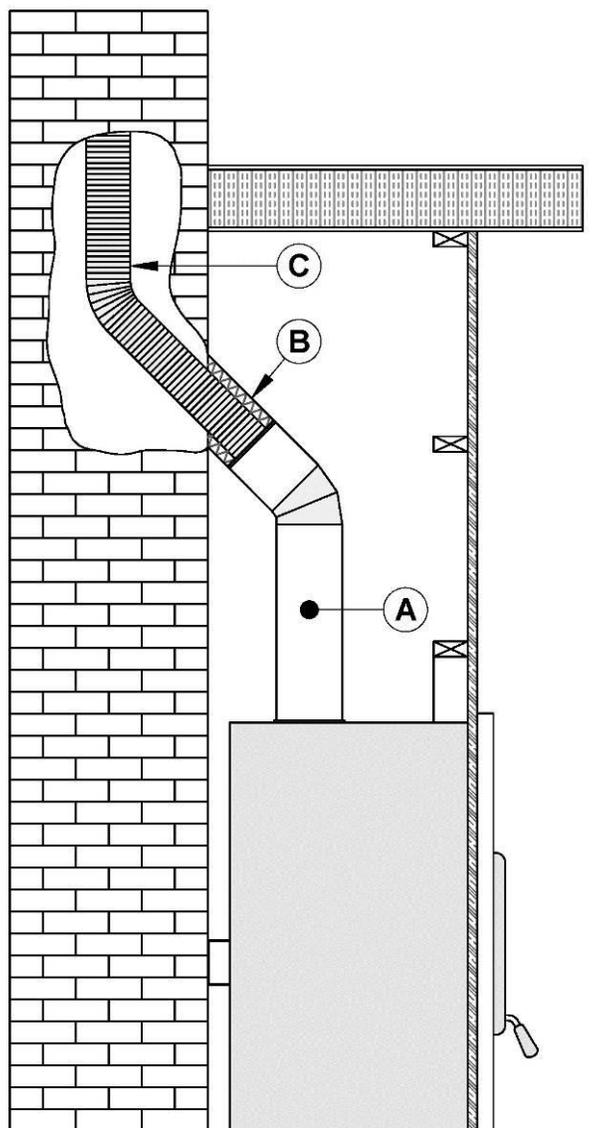
Figure 51 : Installation avec une cheminée de maçonnerie
