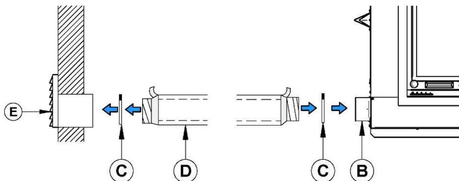
Figure 29 : Installation de la prise d'air frais
