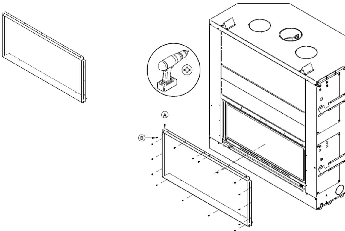
Figure 32 : Installation du contour pour finition de maçonnerie
