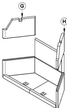
Figure 38 : Panneaux supérieurs droit et gauche
