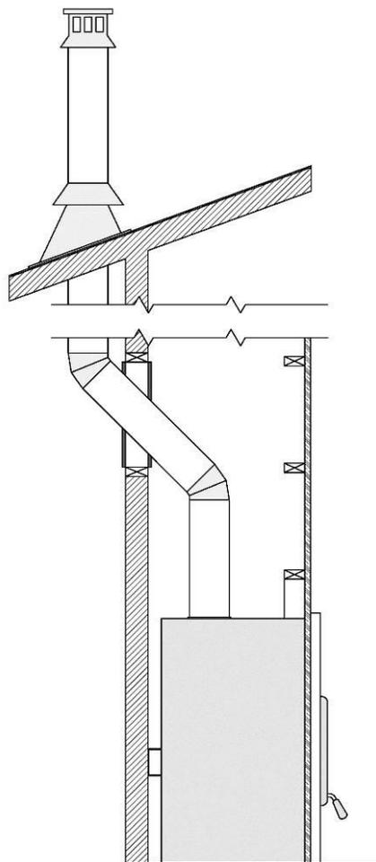
Figure 46 : Installation avec déviation extérieure
