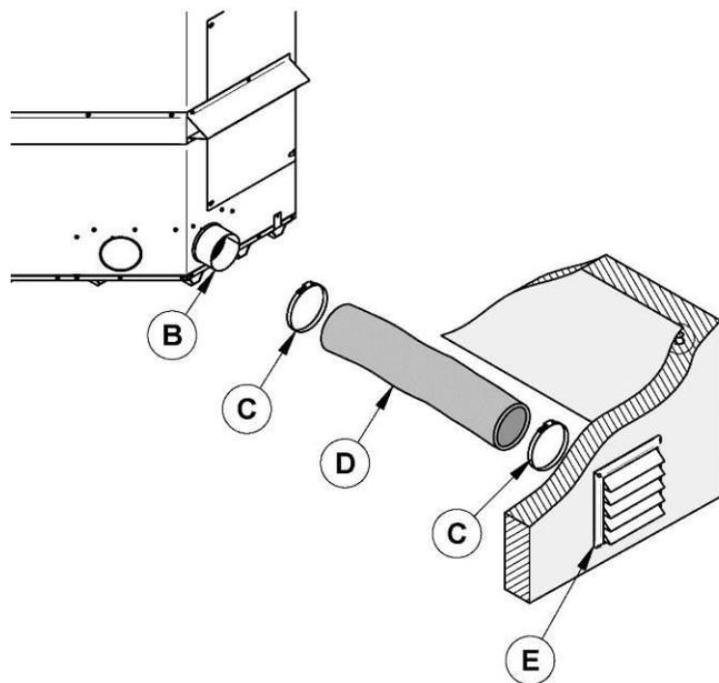
Figure 26 : Installation de la prise d'air frais
