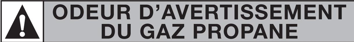
En cas de fuite de gaz, une odeur de gaz doit être perceptible parce que le propane contient un odorisant. Ce signal demande une action immédiate!
