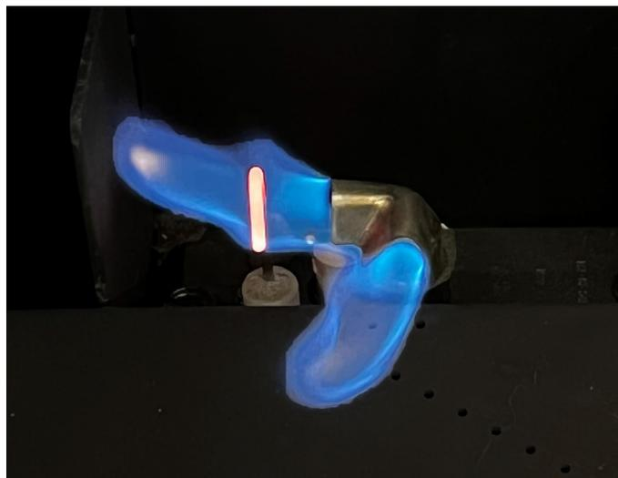
Figure 2: Flamme du pilot Proflame II
