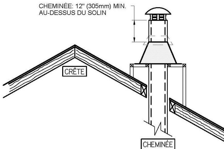
**Note : L'enceinte de la cheminée sur le toit doit être de la même dimension que la base du solin.**
