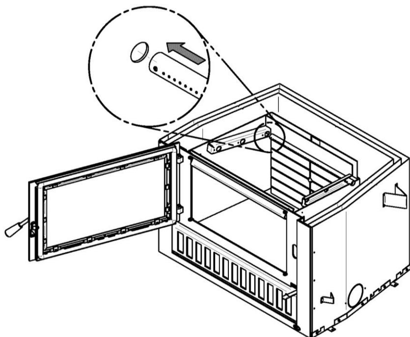
5. Insérer le tube dans le trou correspondant de la canalisation de gauche.
