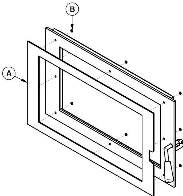
Positionnez le revêtement (A) sur la porte et fixez-le en place en utilisant les 8 écrous (B) et fournies.
