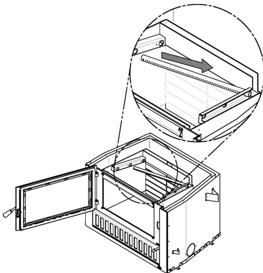
4. En commençant vers l'arrière, Incliner et insérer le tube d'air secondaire arrière dans le trou du fond de la canalisation droite. Ensuite, levez et poussez le tube vers la droite dans le trou correspondant de la canalisation de droite.
