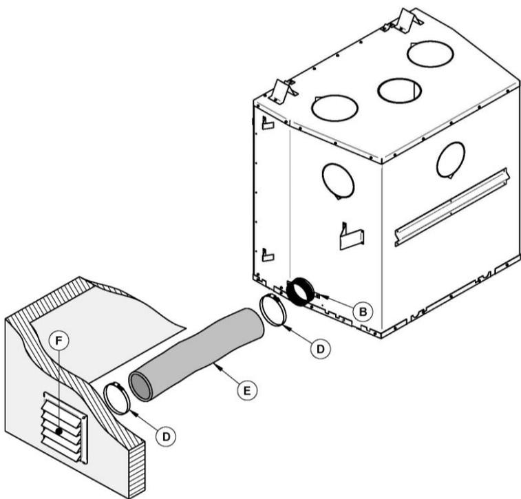
3. Par la suite, installez le tuyau flexible\* (E) (non fournie) sur l'adaptateur d'entrée d'air frais (B) à l'aide d'un des collets de serrage (D) fourni. Fixez l'autre extrémité au capuchon de prise d'air (F) à l'aide du deuxième collet de serrage (D). Le capuchon de prise d'air (F) doit être installé à l'extérieur de votre habitation.
