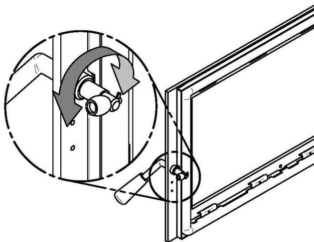
3. Réinstallez l'arrêt de poignée (A) et les 2 vis (B).
