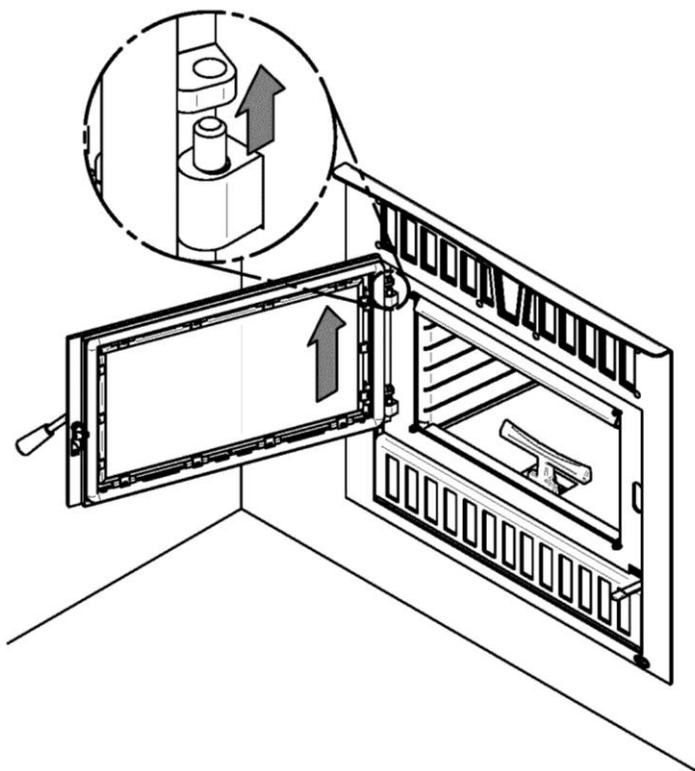
2. Dévissez légèrement les vis de pressions situés sur les gonds de porte inférieur et supérieur à l'aide d'une clef Allen 3/32" pour libérer les tiges pentures ajustables.
