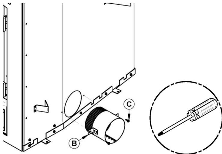
2. Fixez l'adaptateur d'entrée d'air frais (B) sur la chemise du foyer à l'aide de 2 vis (C) fournies avec l'ensemble.
