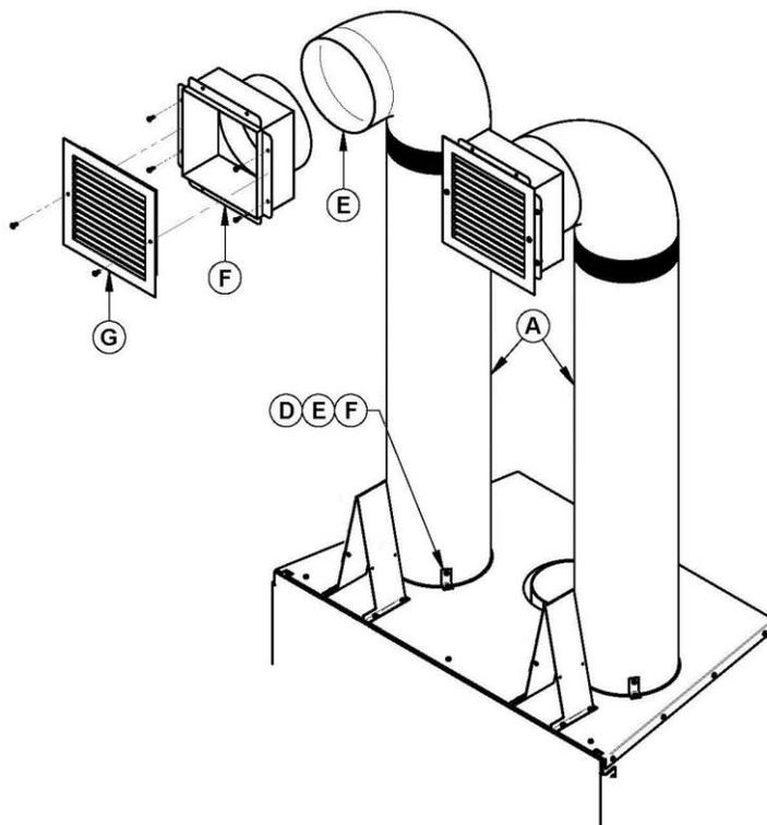
Les sorties d'air chaud peuvent être installées dans la même pièce que le foyer, ou l'une et l'autre des sorties peuvent être installées dans des pièces adjacentes ou situées à l'étage. Si on installe les sorties à des hauteurs différentes, la sortie la plus élevée aspirera plus de chaleur.
