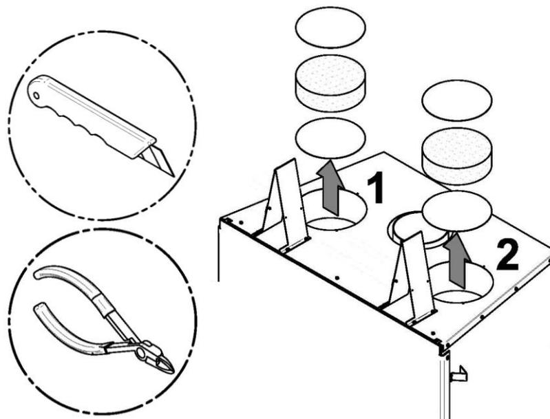
2. Fixez les 6 équerres de fixation (B) à l'aide de 6 vis (C) sur le dessus du foyer (3 par conduit). Insérez les conduits (A) (non-fournis) dans chaque ouverture et fixez-les en place dans les équerres de fixation (B) à l'aide de 6 vis auto-perforantes (D).
