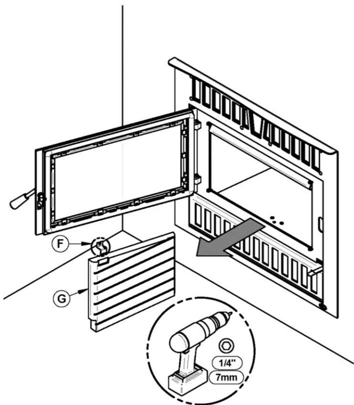
3. À l'aide d'une visseuse électrique et d'un embout hexagonal 1/4" (7 mm), retirer le support de pierre (F) et la pierre latérale gauche (G).
