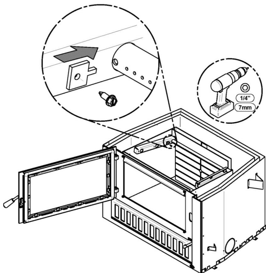
6. Insérer un support de rétention dans le dernier trou à gauche du tube. À l'aide d'une visseuse électrique et d'un embout hexagonal 1/4" (7 mm), Fixer le support dans le trou approprié dans la canalisation avec une vis. Installer le coupe-feu puis répéter les **étapes 4, 5 & 6** pour les tubes restants.
