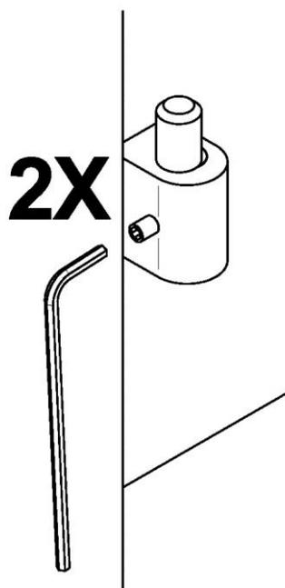
3. À l'aide d'un tournevis plat, tournez les tiges de pentures ajustables dans les sens indiqués pour ajuster les portes (vous référer au tableau pour le sens de rotation). Resserrez toutes les vis de pression sur les gonds de portes lorsque ces dernières sont aux positions désirées.
