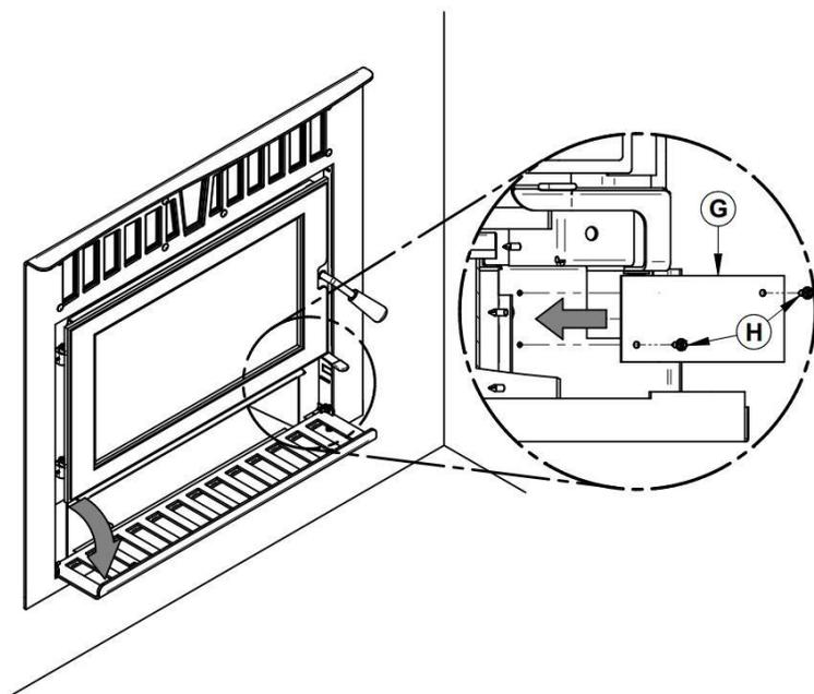
4. Lorsque l'ensemble d'entrée d'air frais est utilisé, le bouchon d'entrée d'air fourni doit être installé\*. D'abord, ouvrez la grille du bas de la façade. Ensuite, le bouchon (G) doit être vissé dans le boîtier de contrôle d'air sous le bras de contrôle à l'aide des deux vis fournies (H) avec le foyer. Une fois vissé, le bouchon permettra de prendre son air via l'ensemble d'entrée d'air frais.
