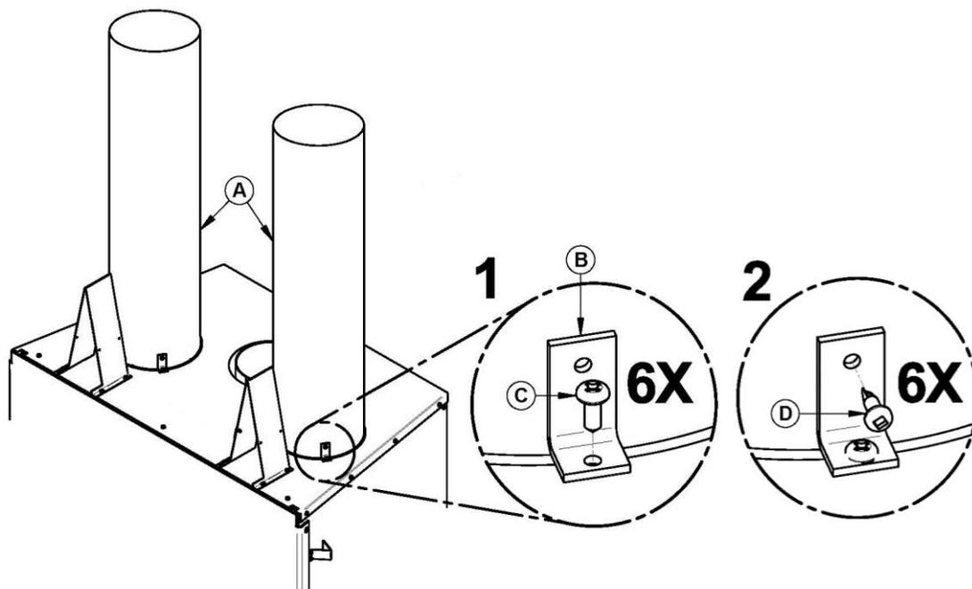
3. Fixez les conduits (A) aux coudes 90° (E) à l'aide de vis auto-perforantes (3 par coude). Insérez les cadres (F) dans les sorties des coudes (E), appuyez-les à l'arrière du revêtement non-combustible et fixez-les au mur à l'aide de vis derrière ce dernier. Fixez l'embouchure du cadre (F) à la sortie du coude (E) à l'aide de 3 vis auto-perforantes dans chacun. Fixez les grilles décoratives aux cadres à l'aide de vis.
