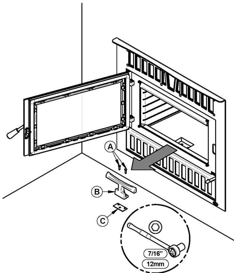
1. À l'aide d'une clef à rochet et d'un embout hexagonal 7/16" (12 mm), dévisser les 2 boulons (A) et retirez l'andiron (B). Si nécessaire, remplacer l'isolant (C) situé sous l'andiron (A).
