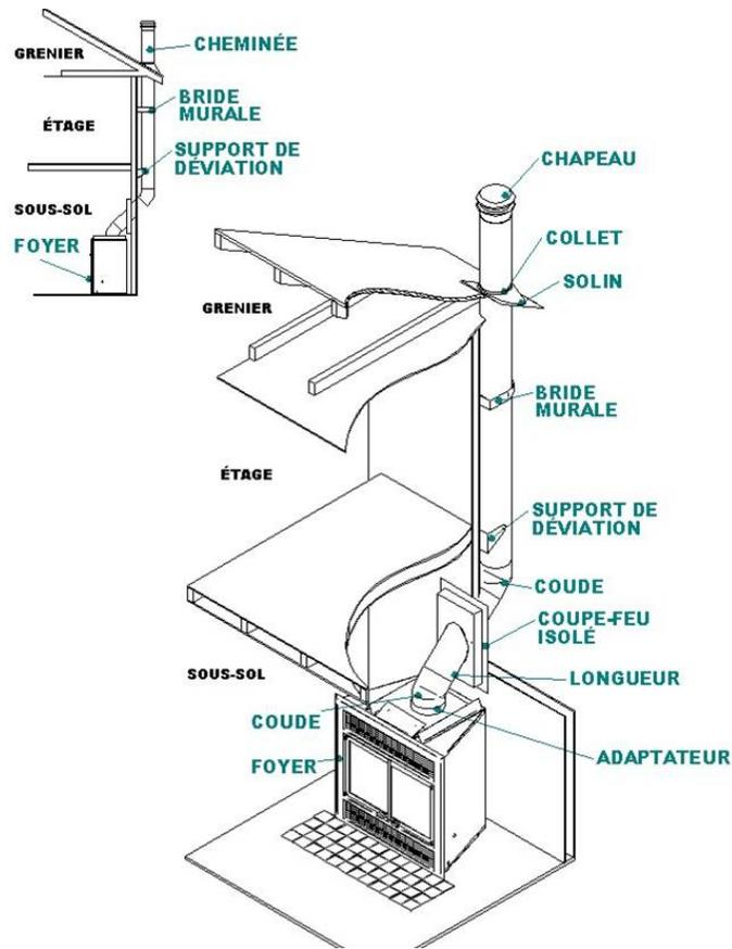
Figure 10 : Installation chase isolé
